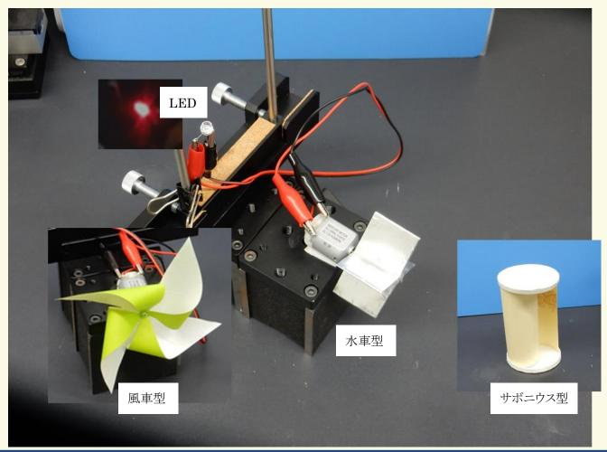
**各自**で水車型,風車型,サボニウス型を作って試します。 磁石と電流からどの羽根が明るくなるか,発電できるかを観察します。
